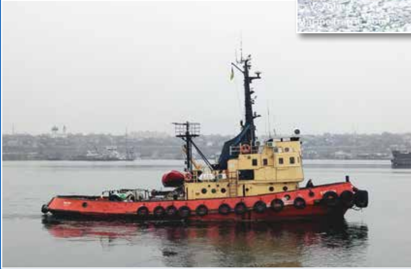
VYKTORY ex SVEASUND - built 1969 Elsflether Werft - 26,1 x 7,6 x 3,6 m. Main engine Deutz, output 1.320 bhp
